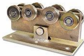
VO 555 2 476,- Kyvny nosny vozíček pro výrobu samonosné posuvné brány do 6,5m, pouzdřená ložiska, zinkovaný ( použijte 2 ks pro max. zatížení do 600kg), max. výnos 6,5m, do C profilu CP 555
