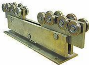
VO 601 7 436,- Dvojity kyvny nosny vozíček pro výrobu samonosné posuvné brány do 10m, pouzdřená ložiska, sulfátovaný ( použijte 2ks pro max. zatížení 800kg), max. výnos 10m, do C profilu CP 555
