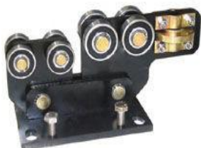
VO 666 8 756,- Dvojity kyvny nosny vozíček pro výrobu samonosné posuvné brány do 15m ( použijte 2ks pro max. zatížení 1 200kg) zapouzdřená ložiska, sulfátovaný, do C profilu CP 666
